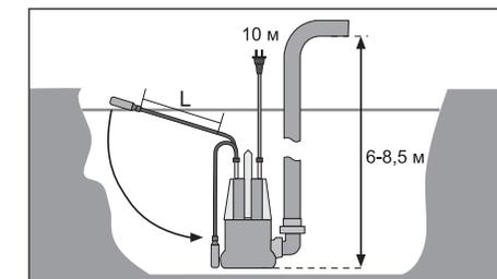
**Примітка!** Слід мати на увазі, що рівні ввімкнення і вимкнення насоса регулюються **ОДНОЧАСНО**. Тому, при установці визначеного верхнього рівня переконайтеся, що в нижньому положенні вимикач забезпечує своєчасне (до оголення водозабірних отворів в нижній частині) ввімкнення насоса. Також візьміть до уваги, що при зменшенні довжини L зменшується різниця рівнів ввімкнення і вимкнення.
